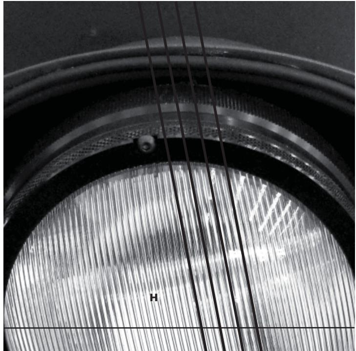
**IT** In caso sia necessario riallineare il vetro interno (H), è necessario allentare la vite (K) opposta all'alella (J) senza svitarla completamente; ruotare il vetro fino a che la rigatura non sia nuovamente perpendicolare all'asse orizzontale del kit, quindi serrare la vite (K).
