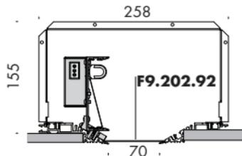
esempio di installazione linea di luce singola su taglio da 140mm
