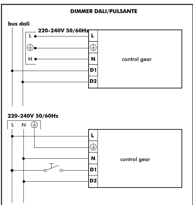
**Schema di collegamento alimentatore dimmerabile tramite pulsante**
