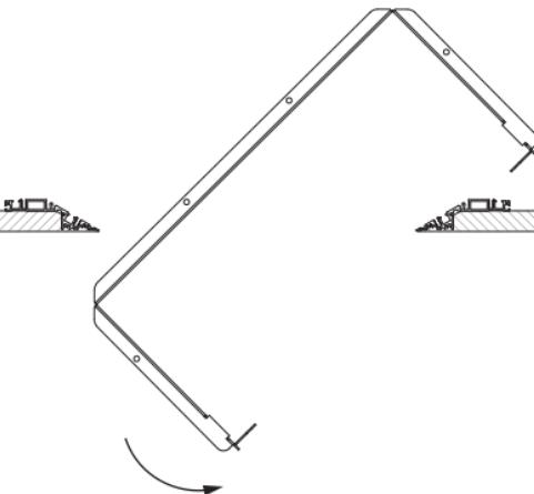
**IT** inserire il kit (A) all'interno del taglio. quando il faretto arriva all'altezza del cartongesso, ruotare il tutto per facilitarne l'inserimento.
