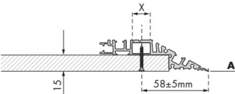
**IT ATTENZIONE:** se viene utilizzato un cartongesso inferiore a 15mm (europa), spessorare adeguatamente in modo che la punta estrema (A) della cornice sia sullo stesso livello del cartongesso.
