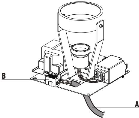
**I** Una volta inserito il cavo di alimentazione (A) nel passacavo situato sul corpo, eseguire il collegamento elettrico dei cavi alla morsettiera (B). Collegare il cavo giallo/verde di terra al morsetto di terra contrassegnato dal simbolo  $\perp$ .
