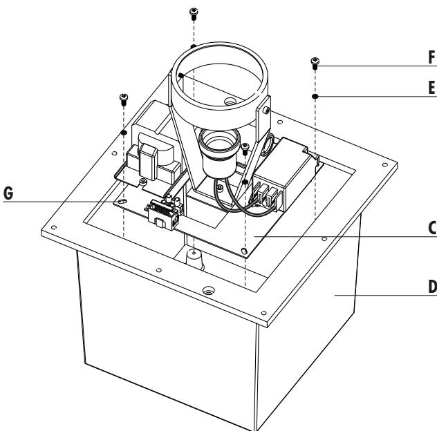
**2** **I** Inserire il kit (C) nel corpo (D) e fissarlo con rondelle (E) e viti (F) in dotazione tramite le asole (G).
