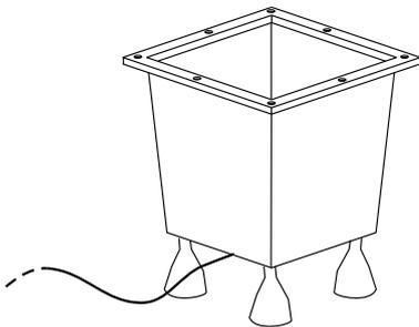
**1** **I** Inserire il cavo di alimentazione del kit nell'apposito passacavo situato sul corpo e serrare quest'ultimo.
